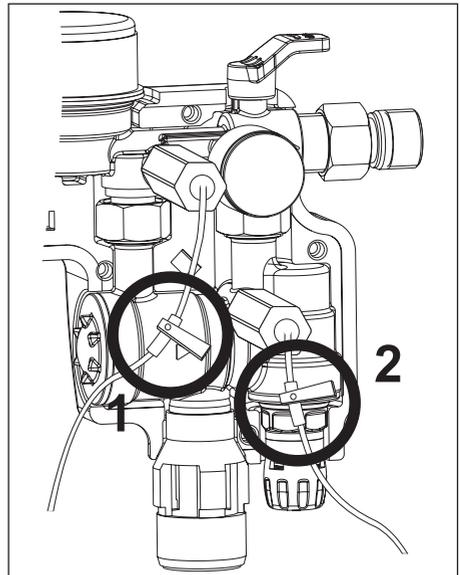
Montieren Sie das Messgerät und öffnen Sie die beiden Absperrungen.
