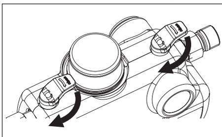
Öffnen Sie das Nadelventil 1 und lassen Sie die Armatur über das Nadelventil 1 langsam den Druck ab (wenige Tropfen).
