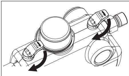
Schrauben Sie mit dem Schlüssel die Kappe ab.
