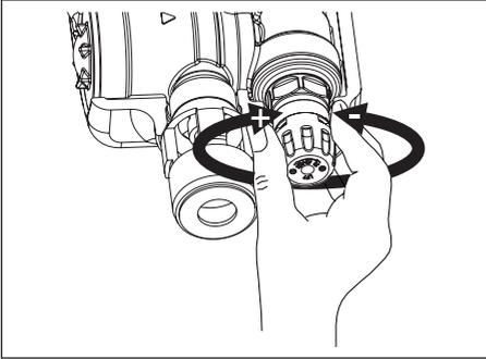
Ggfs. den Druck der Heizungsanlage auf den gewünschten Fülldruck absenken bzw. erhöhen.
